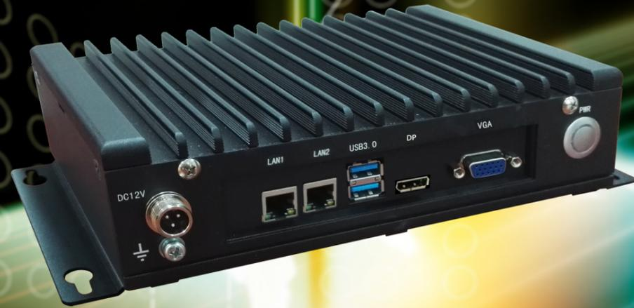
产品采用最新Intel Braswell平台处理器冰翅结构嵌入式系统，基于Intel Braswell N3060/N3160处理器；1条SODIMM内存插槽，支持DDR3L 1066/1333/1600MHz，最大可支持8GB；支持VGA+ LVDS+ DP显示接口，支持独立三显；可扩展6个COM，标准DB9座，1个SATA，8个USB接口（其中2个USB3.0接口、6个USB2.0插针），2个LAN，支持1个Mic\_in，2个Speaker\_out，提供一个音频功放；提供2个MINI PCIe插槽，支持Mini-PCIE无线网卡/MSATA可选，1个SIM卡槽（支持3G模块）。
